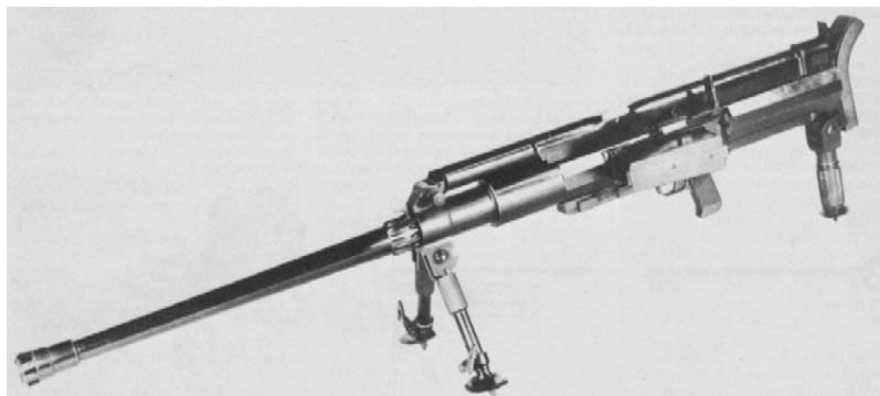
Rusznica przeciwpancerna (karabin przeciwpancerny) Solothurn kal. 20 mm produkcji szwajcarskiej.
